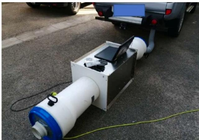
Figure 2 : Filtre ALEPH positionné en sortie du tuyau d'échappement d'un véhicule
